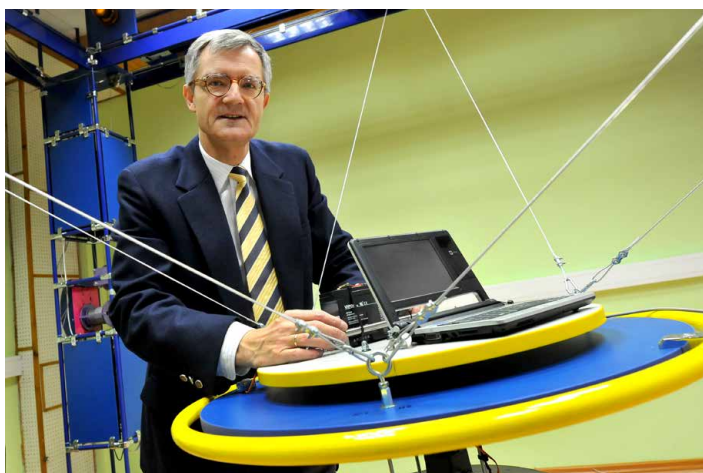
Prof. Andrzej Bartoszewicz przy platformie wiszącego robota o sześciu stopniach swobody fot. arch. PL
